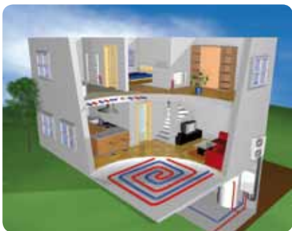
Tepelné čerpadlo vzduch voda umiestnené vo vonkajšom prostredí
